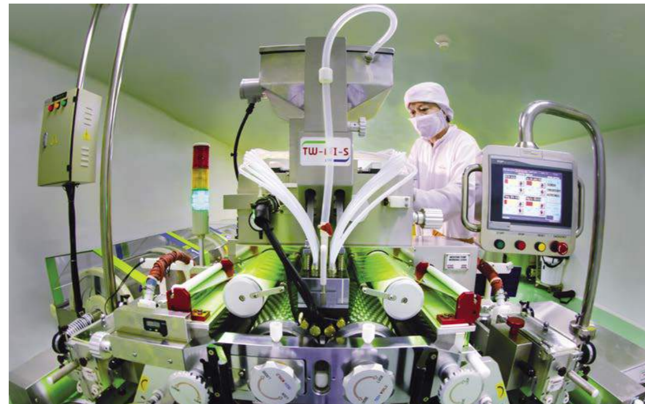
Máy sản xuất viên nang mềm của nhà máy nang mềm DHG
