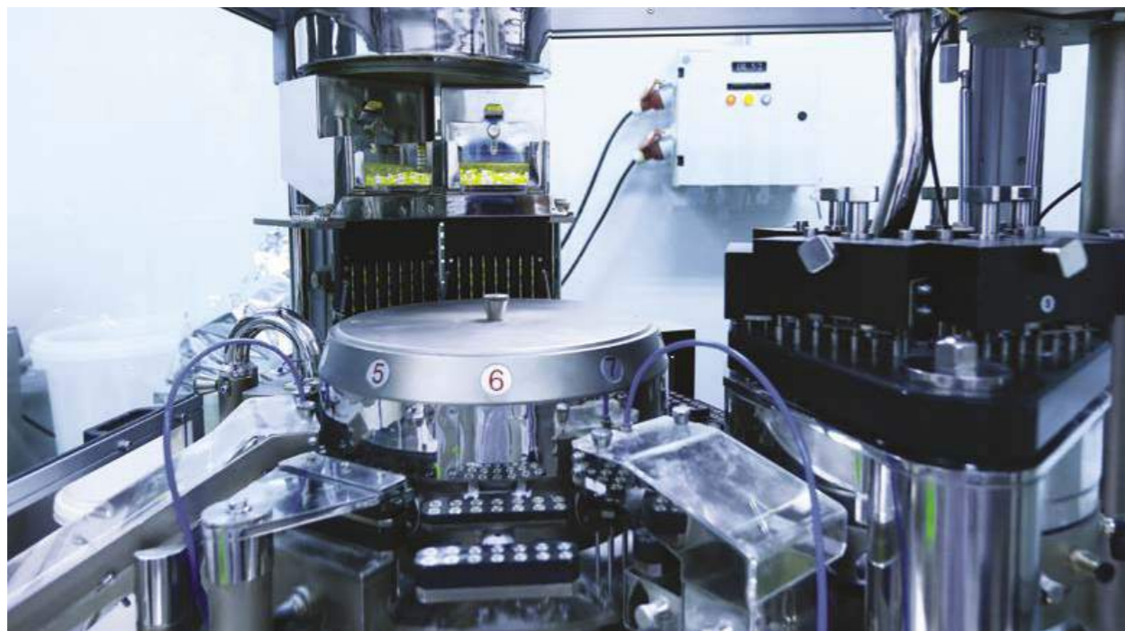
Máy đóng nang tự động tại nhà máy mới của DHG Pharma
